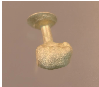
図2 光重合で製作した原型を用いた鑄造体 鑄造体表面に肌荒れが観察される
